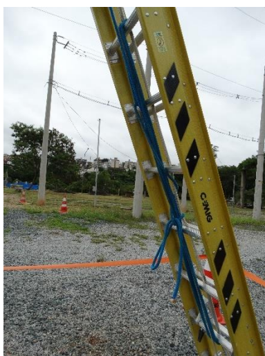
Foto demonstrando a corda de amarração da escada
