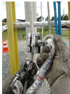
Foto demonstrando dois trava-quadras instalados na mesma linha de vida.
