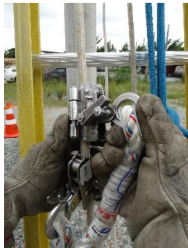
Foto demonstrando o trava-queda travado
