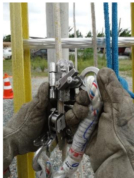
Foto demonstrando o trava-queda travado
