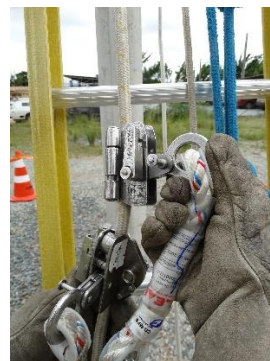
Foto demonstrando o trava-queidas destravado
