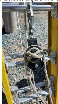
Foto demonstrando a carretilha travada preparada para retirar o trava-quedas e talabarte da vítima.
