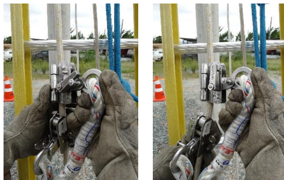
Foto demonstrando o trava-queda travado
