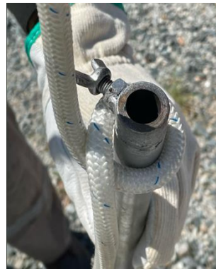
Laçada para içar o suporte com a bandeira para evitar a queda.
